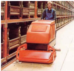
Una lavasciuga con uomo a terra dotata di gruppo pre-spazzante montato anteriormente.
