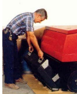
In foto un operatore sta svuotando il contenitore dei rifiuti di un gruppo pre-spazzante montato anteriormente ad una grossa spazza-lava-asciuga con uomo a bordo.
